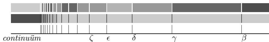
Figuur 1.6 Absorptie en emissie spectrumlijnen in waterstofdamp. Een absorptielijn bij energie E (‘zwarte’ lijn in gekleurde achtergrond) ontstaat als een elektron een foton met energie E vangt; dat kan alleen als E ook het energieverschil tussen twee elektronniveaus is. Een emissielijn bij dezelfde energie E (‘gekleurde’ lijn in zwarte achtergrond) ontstaat doordat het aangeslagen elektron weer terugvalt.
