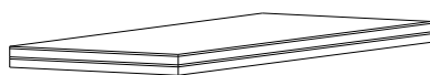
a Een vlakke-plaatcondensator; aan weerszijden van een isolerende, diëlektrische, vlakke plaat zijn geleidende, metalen, folies aangebracht.
